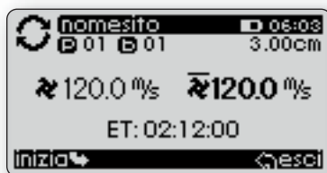
Visualizzazione display durante la misura di portata
